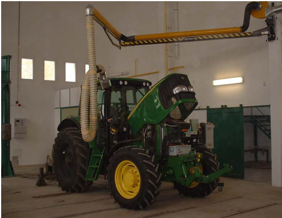
Traktormotor TLT fékezése a laboratóriumban
