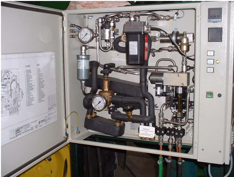
PIERBURG PLU-116H laboratóriumi hajtóanyag fogyasztásmérő
