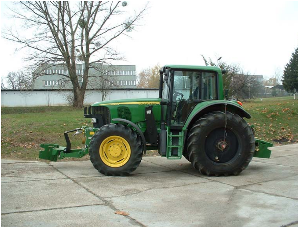
A szántóföldi mérésekhez kialakított, és felműszerezett mérőtraktor
