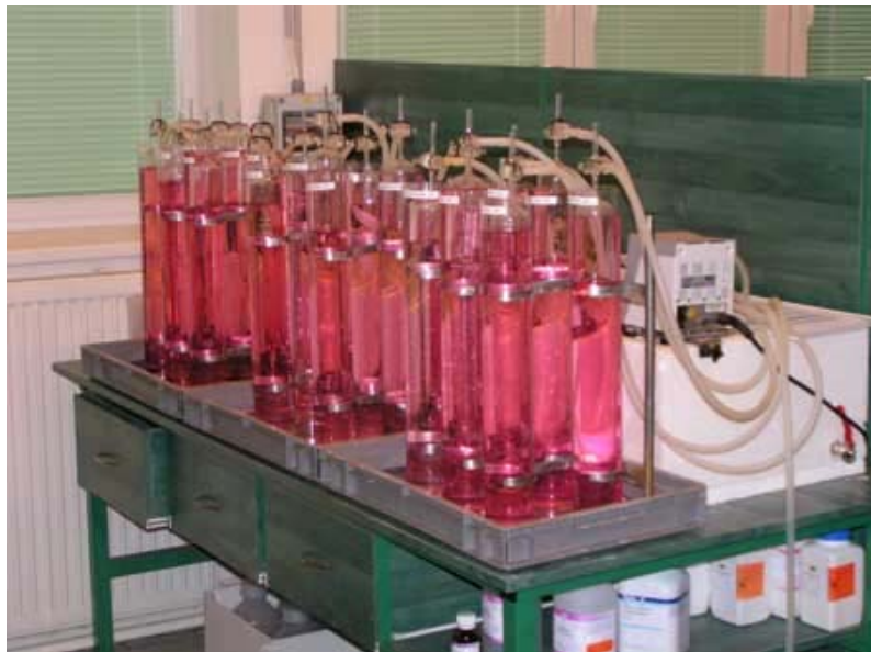
20 darab 1 literes kísérleti reaktorról működő biogáz kihozatali mérőrendszer
