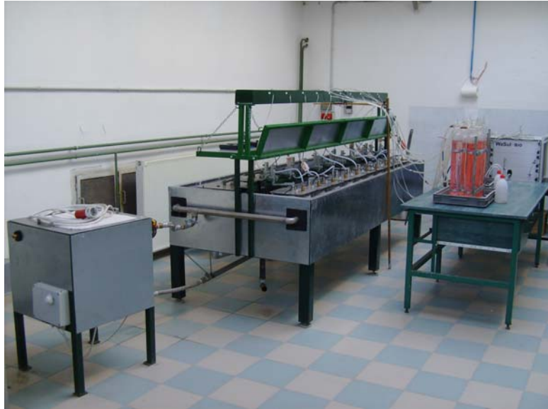
10 db 10 literes kísérleti reaktorról működő biogáz kihozatali mérőrendszer
